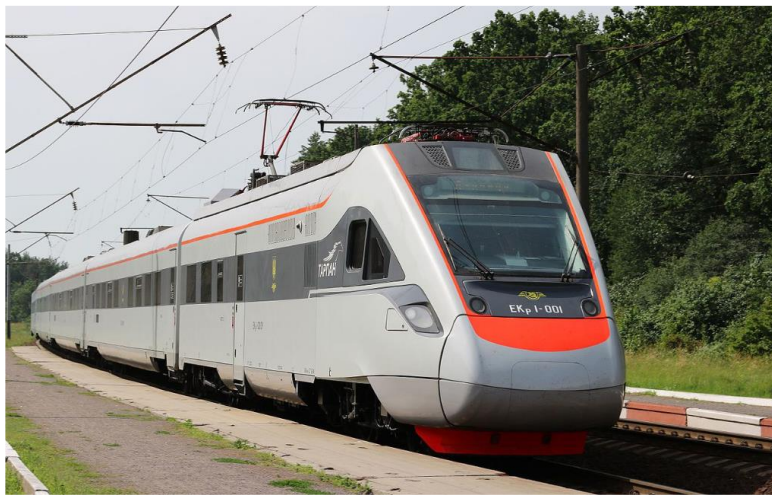
ЕКр1 «Тарпан» — двосистемний електропоїзд виробництва компанії Крюківський вагонобудівний завод
