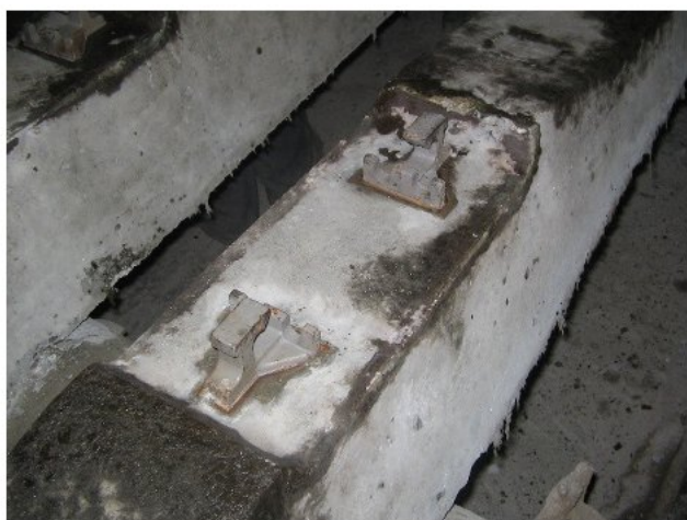
Рисунок 7.10 – Виготовлення шпал Ш1-1-PRS на Коростенському ЗЗБШ: а - 10-гніздова форма для шпал Ш1-1, перероблена для виготовлення шпал Ш1-1-PRS; б -
