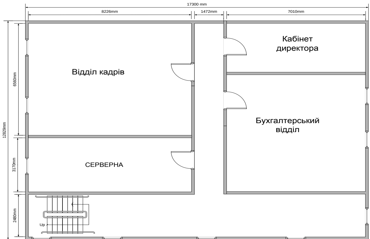
Рисунок 3.3 - План другого поверху офісної будівлі
