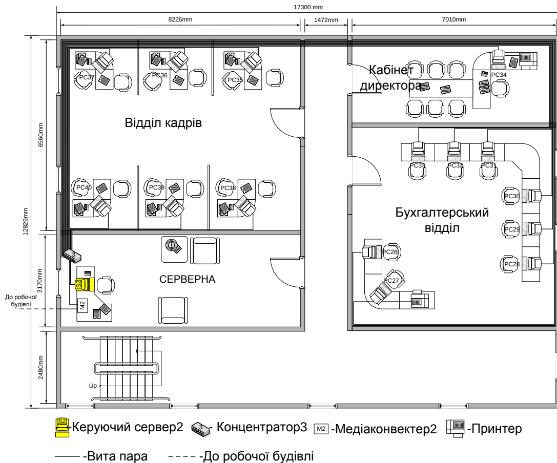
Рисунок 3.5 - Розташування обладнання на 2-гому поверсі офісної будівлі
