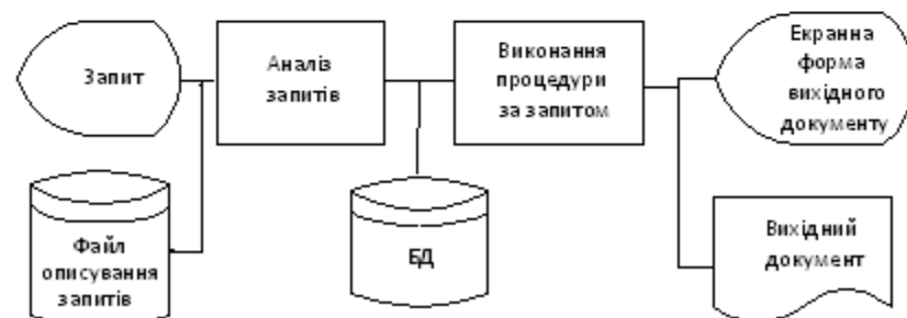
Рисунок 3.2 – Схема формування вихідних документів в АРМ
