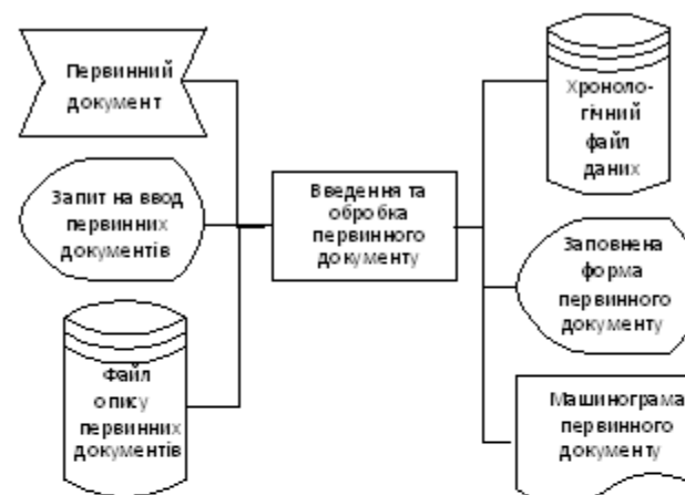
Рисунок 3.1 – Схема формування вхідних документів
