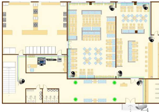
Рисунок 2.16 – Розміщення контрольного пункту охорони
