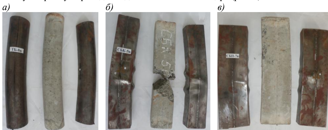
Рис. 5. Зовнішній вигляд бетонного ядра і сталеві оболонки після демонтажу колон: а) – кругла колона; б) – квадратна колона; в) – прямокутна колона
