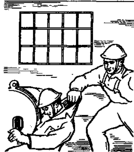
Рис. 2.2. Звільнення потерпілого від дії струму в установках до 1000 В – відтягання за сухий одяг
