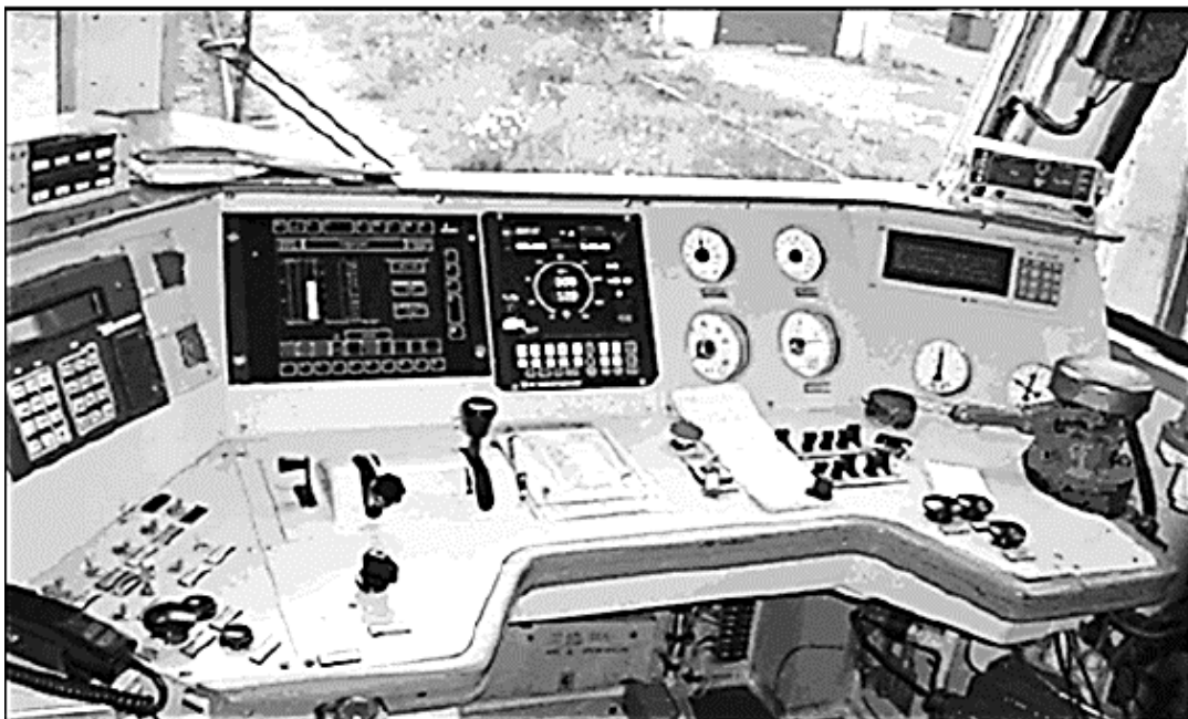
Рис. 2.7. Пульт керування кабіни електровоза ЕП10
