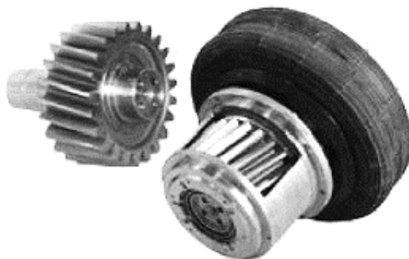
Рис. 2.83. Загальний вигляд модульного вузла малої шестірні електропоїзда EM4
