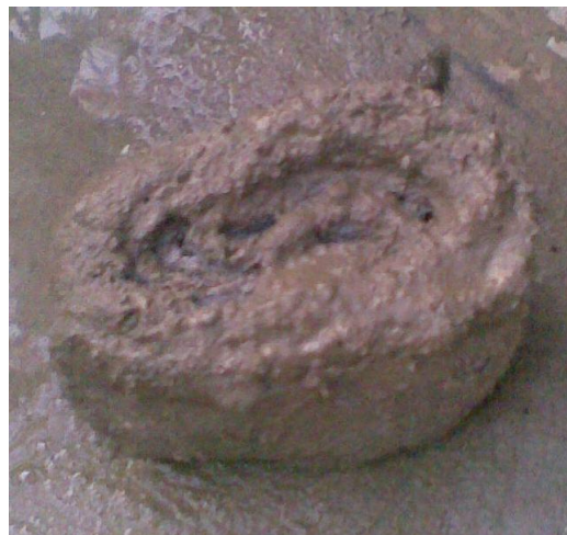
Рис. 10. Рулонний композиційний матеріал (РКМ) у стані, насиченому водою
