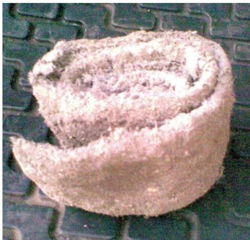
Рис. 9. Рулонний композиційний матеріал (РКМ) в сухому стані
