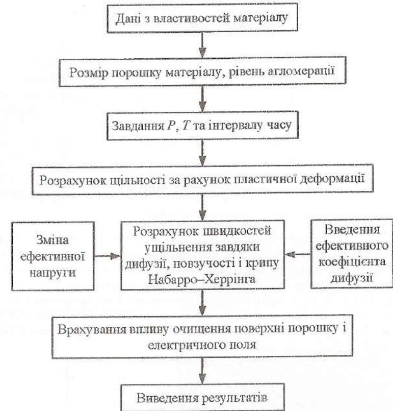
Рис. 2.17. Блок-схема програми розрахунку карт гарячого пресування нанопорошків при прямому пропусненні змінного електричного струму
