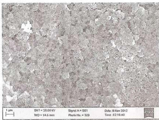
Рис. 7.22. РЕМ зображення зламу зразка ZrO_2 - 20 \text{ мас. \% WC}
