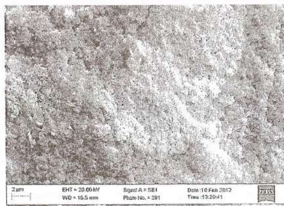
Рис. 7.23. РЕМ зображення зламу зразка ZrO_2 - 20 \text{ мас. \% WC} (спільне осадження)
