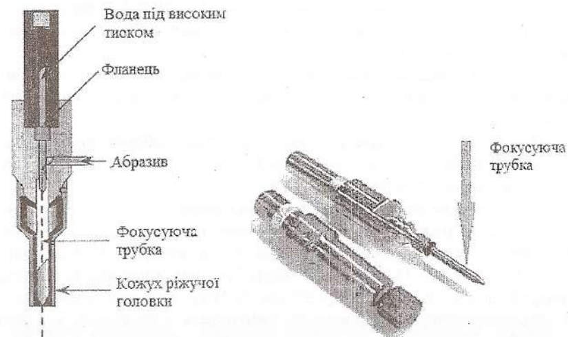
Рис. 7.29. Схематичне і фотографічне зображення ріжучої головки ГАР
