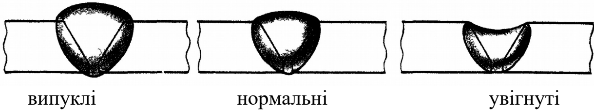
Рисунок 1.5 - Зварні шви за зовнішнім виглядом
