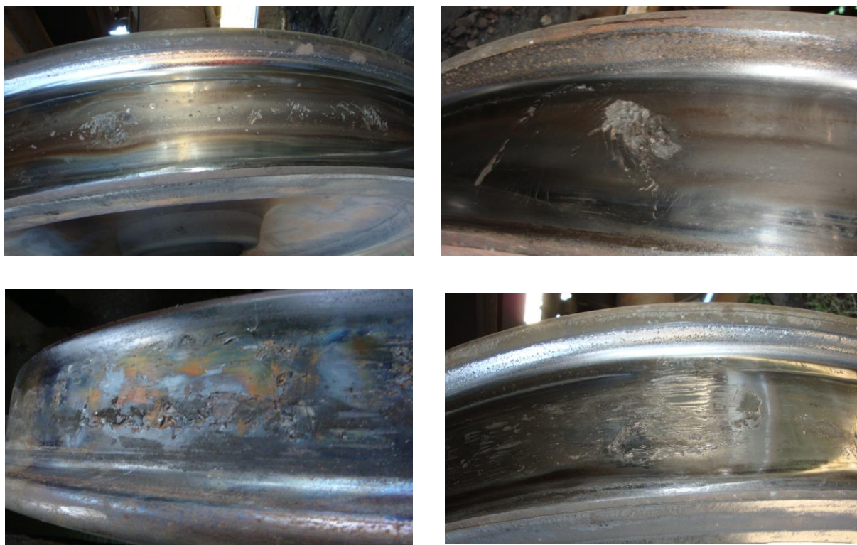
Рисунок 1.4 — Термічні пошкодження поверхонь кочення коліс
