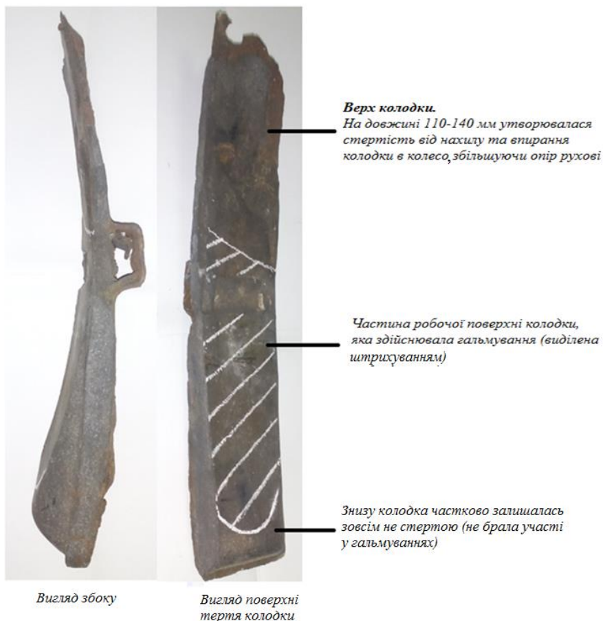
Рисунок 1.3 — Типовий вигляд спотворено зношеної гальмової КОЛОДКИ
