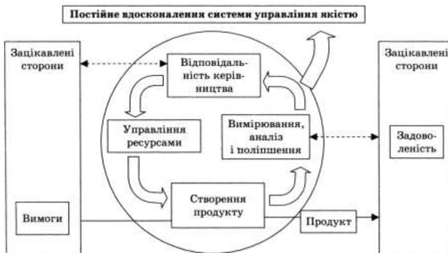
Рис. 1. Модель системи якості, в основу якої покладено процеси
