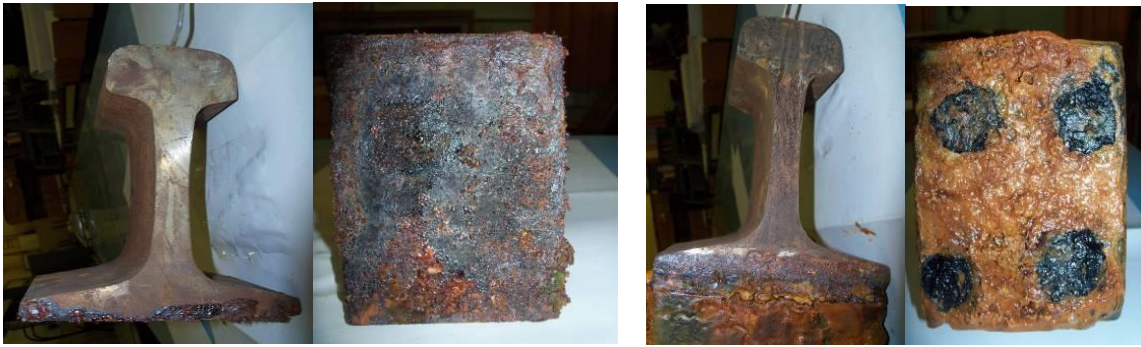
Рис. 24. Зразки рейок після 1850 годин обробки пульсуючою напругою: а) ДК; б) БК
