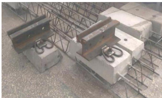
Рис. 9. Пружне рейкове скріплення SRS-T для трамвайної колії на двоблокових опорних елементах. Дослідна партія у галузевій науково-дослідній лабораторії підрейкових основ і спецзалізобетону УкрДУЗТ
