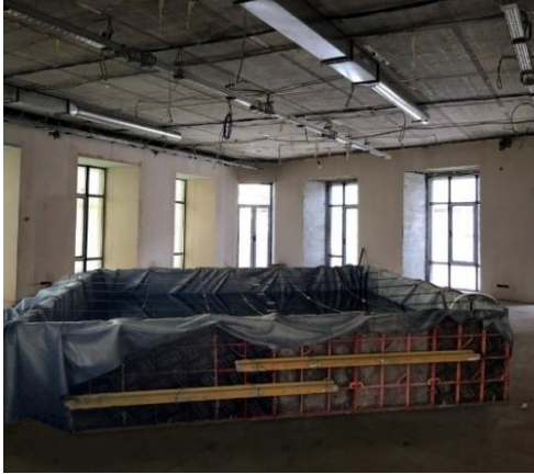
Рис. 15. Резервуар для проведення гідравлічних випробувань (а) та розташування вимірювальних приладів (б)
