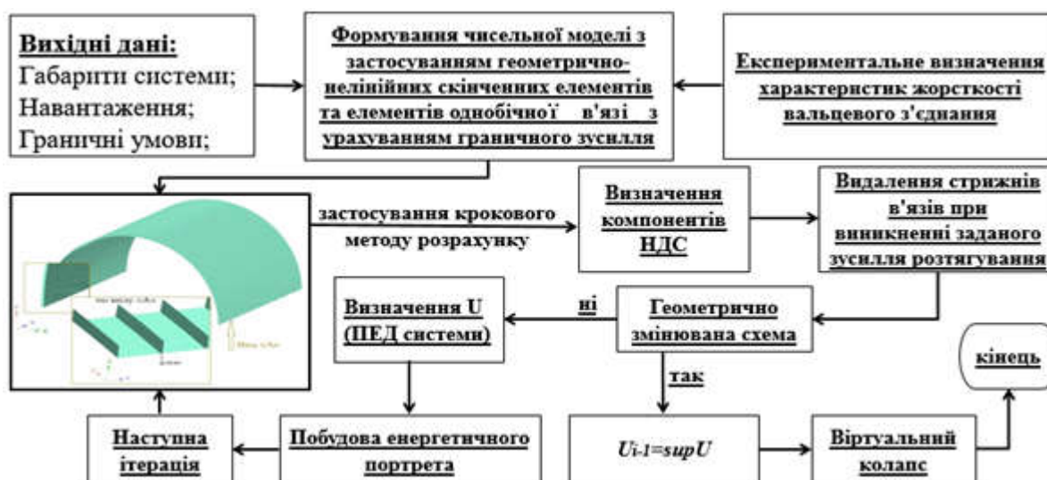
Рис. 7. Блок-схема алгоритму обчислення НДС системи з можливістю відображення настання прогресуючого обвалення
