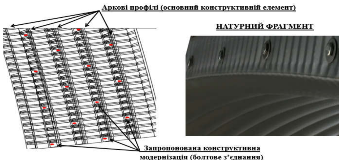
Рис. 12. Схема запропонованої конструктивної модернізації
