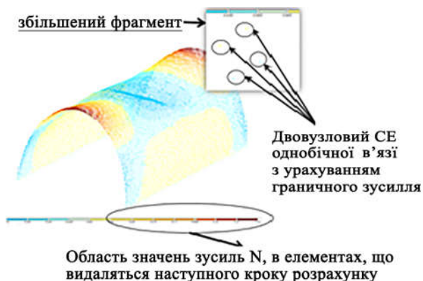
Рис. 11. Зусилля N в скінченних елементах однобічної в'язі на i -тому кроці розрахунку (деформована схема)
