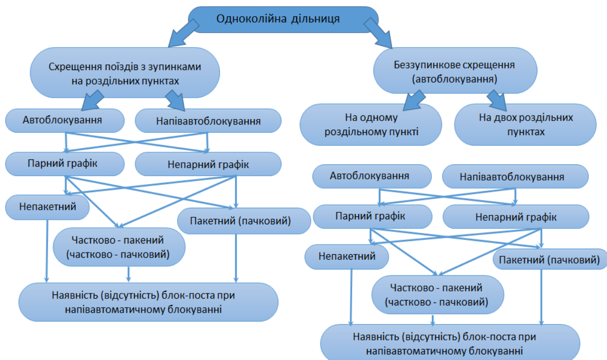
Рис. 4.6. Структура розрахунку наявної пропускної спроможності одноколіїного перегону
