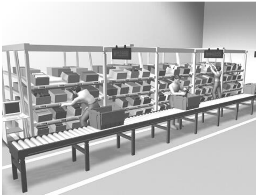
Рисунок 4.8 – Робота операторів логістичного комплексу із системою pick-by-light
