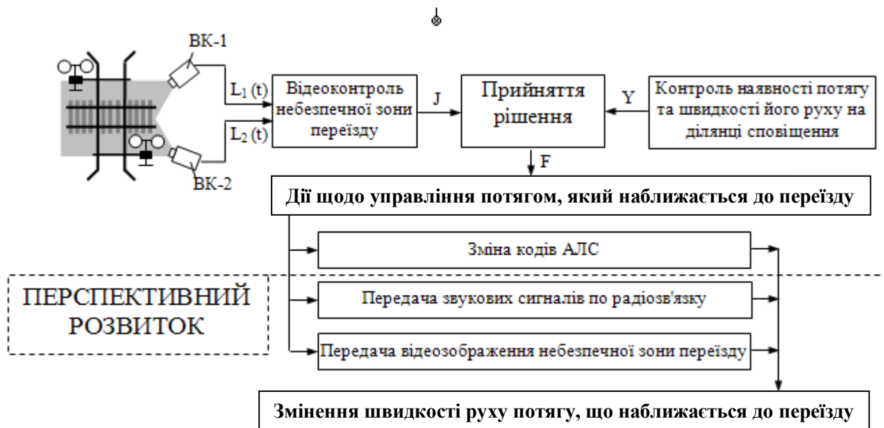
Рис. 3. Структурно-функціональна схема системи автоматичної зміни швидкості руху поїздів через небезпечну зону місць перехрещування маршрутів
