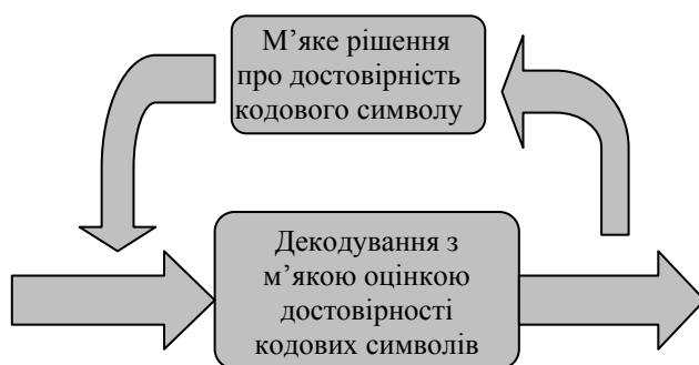
Рис. 2. Схема м'якого декодування з ітеративним обміном м'яких рішень про достовірність символів прийнятої послідовності (схема турбо-декодера)
