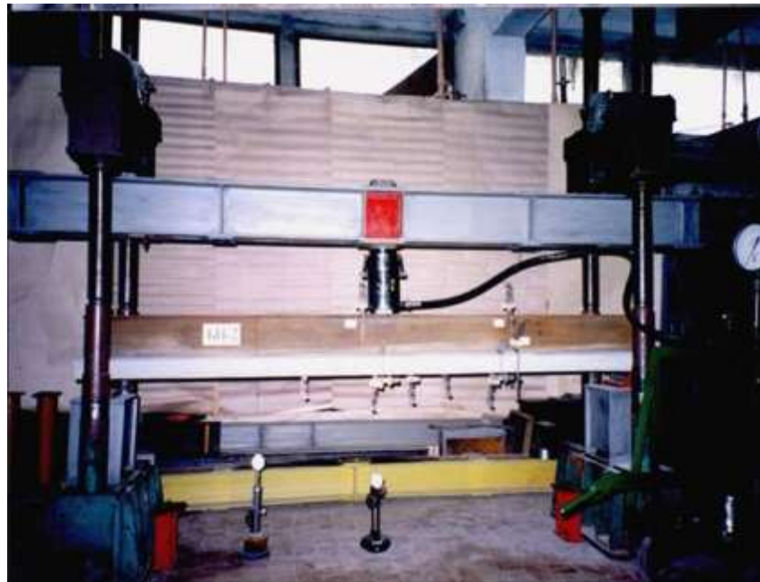
Рис.9. Общий вид испытания локально предварительно напряженной сталежелезобетонной балки с железобетонной полкой в растянутой зоне
