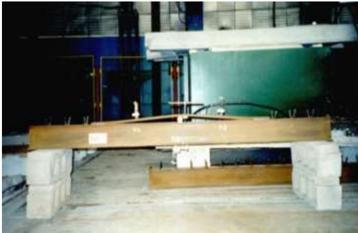
Рис. 8. Осуществление локального предварительного напряжения будущей растянутой стальной части балки БНР-2
