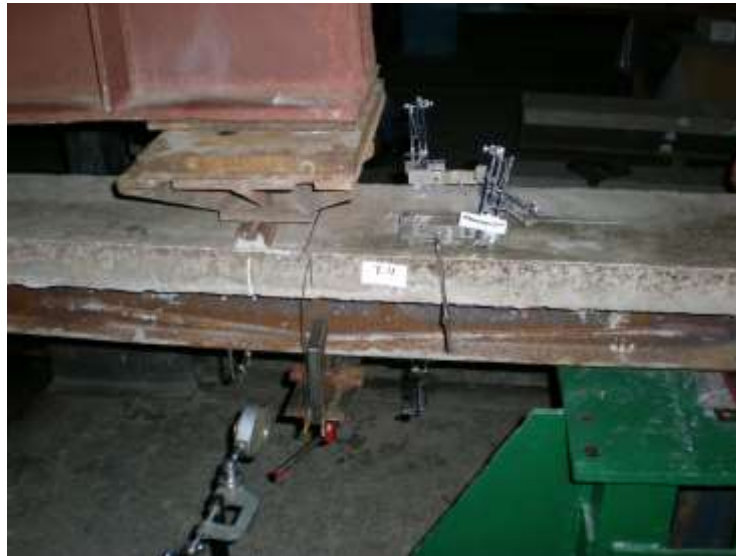
Рис. 14. Осуществление локального обжатия под нагрузкой оттягиванием внешних арматурных стержней ручным винтовым домкратом
