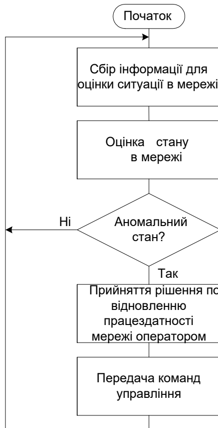
Рис.3. Схема алгоритму управління мережею
