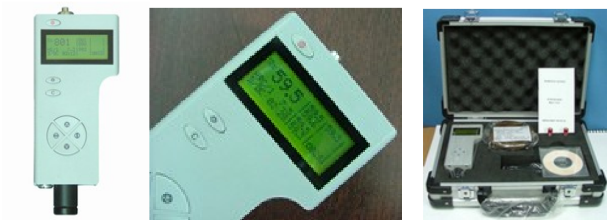
Рисунок 2.5 – Портативний динамічний твердомір модель HLJ-2100
