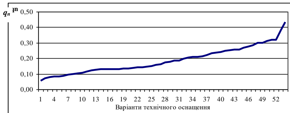
Рис. 4. Залежність q_n від прийнятої технології роботи та технічного оснащення сортувальної станції.
