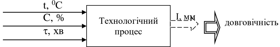
Рис.3.Граф технологічного процесу підвищення довговічності коліс суцільнокатаних рухомого складу:
