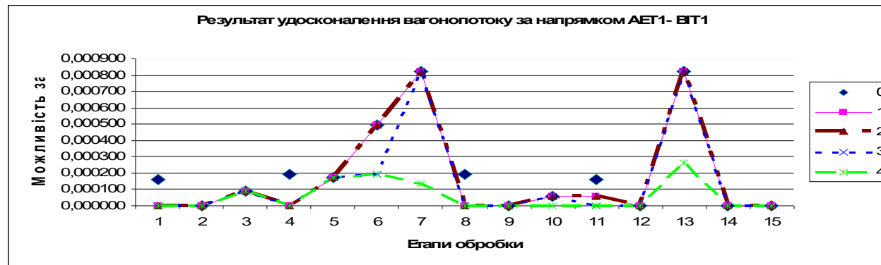
Рис. В.1. Можливість затримки вагонів після 4-х кроків удосконалення при експорті й транзиті зі станції Харків-
