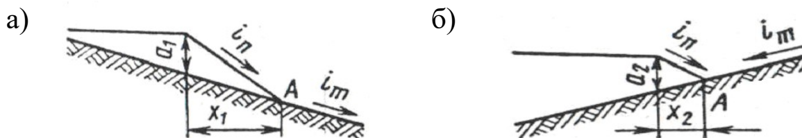
Рисунок 4.2 – Схеми для розрахунку площ земляного полотна на косогірній місцевості при уклонх земляного полотна i_n та місцевості i_m , направлених в один (а) та в різні боки (б)
