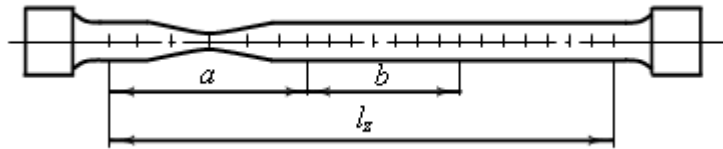
Рисунок 1.5 – Вимірювання довжини зразка
