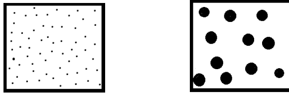
Рисунок 9.4 - Схематичне зображення троститу відпуску (а) і сорбіту відпуску (б)
