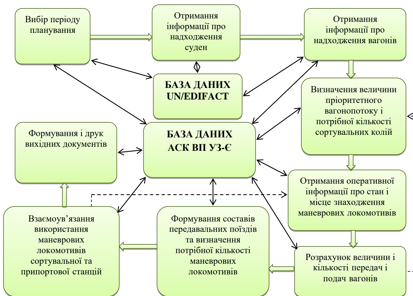
Рисунок 4.1 – Схема функціонування СППР з формування складів передавальних поїздів
