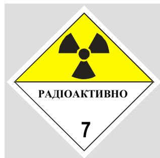
Рисунок 2 – Приклад знака-табло: знак-табло для радіоактивних матеріалів класу 7
