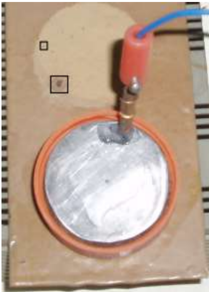
Рис.11. Сталева пластина з бежевим покриттям з місцями пробою (а) і збільшений фрагмент (б)
