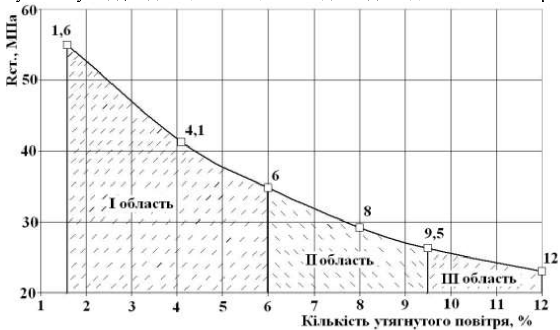
Рис. 1. Залежність міцності бетонів при стиску від кількості залученого повітря
