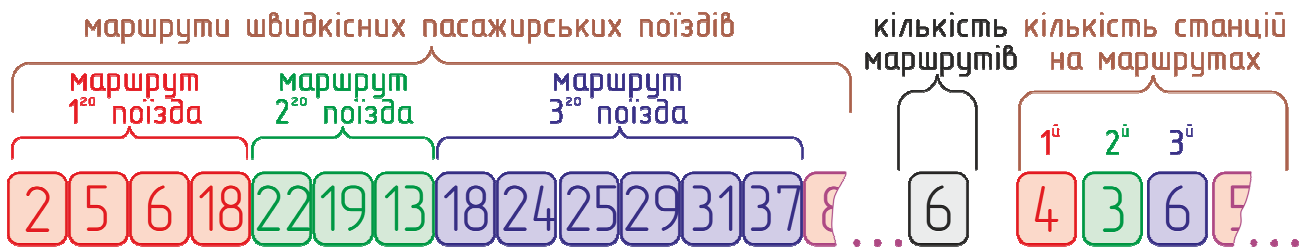
Рис. 1. Схема кодування рішення задачі формування оптимального плану маршрутів швидкісних поїздів у вигляді хромосоми генетичного алгоритму
