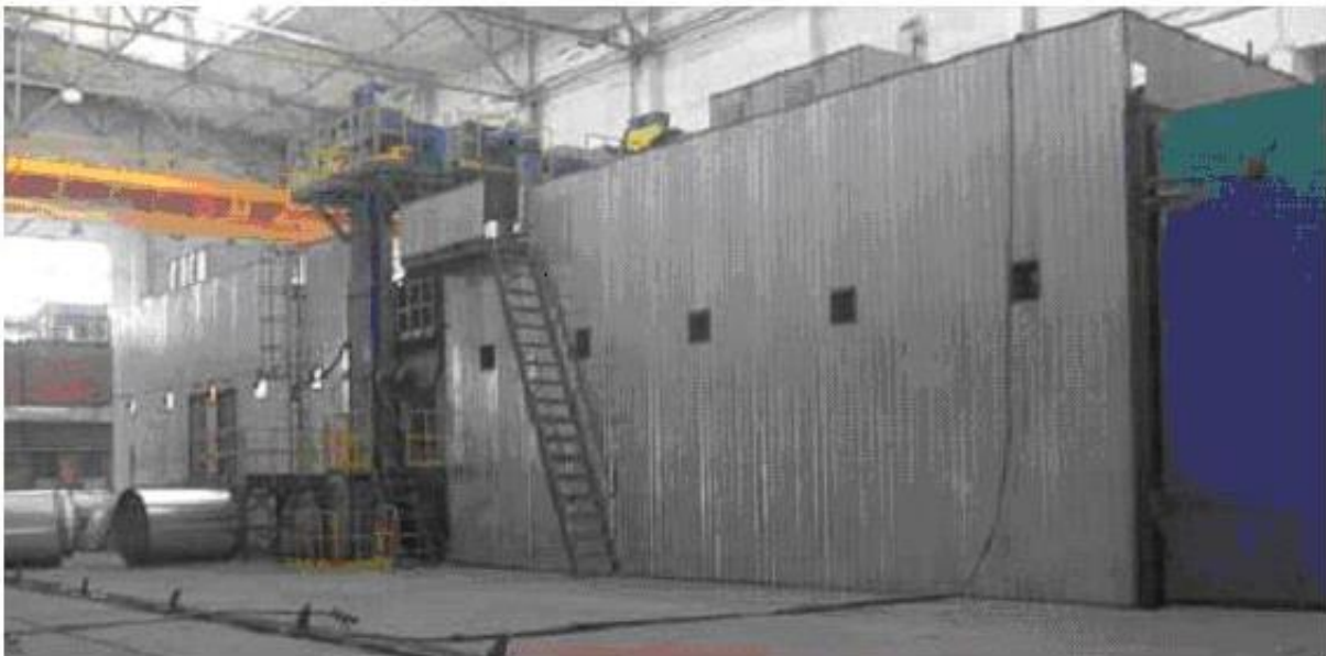
Рисунок 7- Дробометальна камера для очищення вагонів
