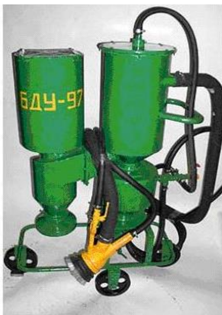
Рисунок 8 – Безпилова дробоструминна установка БДУ – 97
