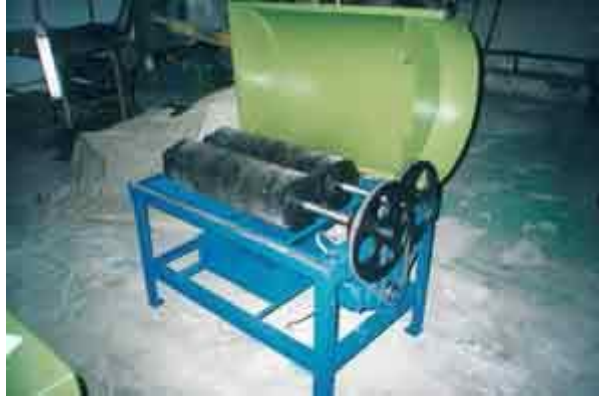
Рисунок 26 – Машина для зовнішнього очищення гідравлічних гасителів коливань
