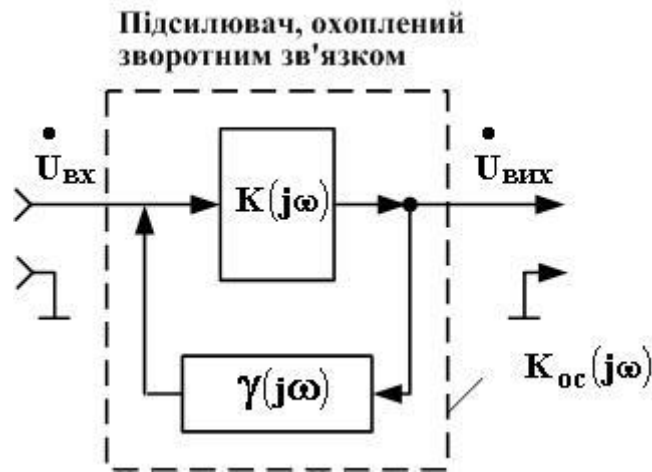
Рис. 4.87. Узагальнена структурна схема підсилювача, охопленого зворотним зв'язком
