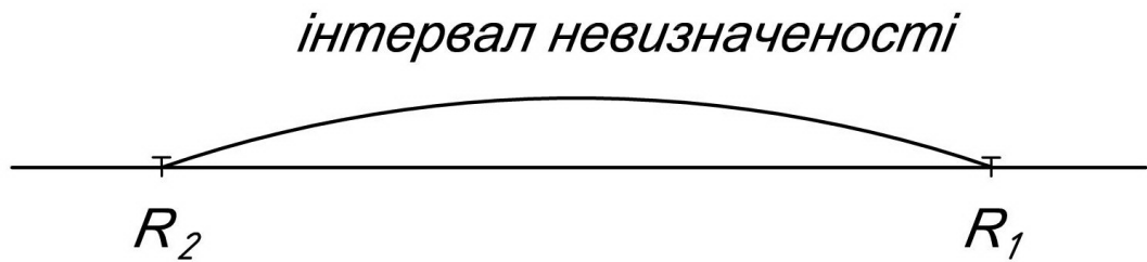
Рисунок 2.5 – Інтервал невизначеності радіуса кривої
