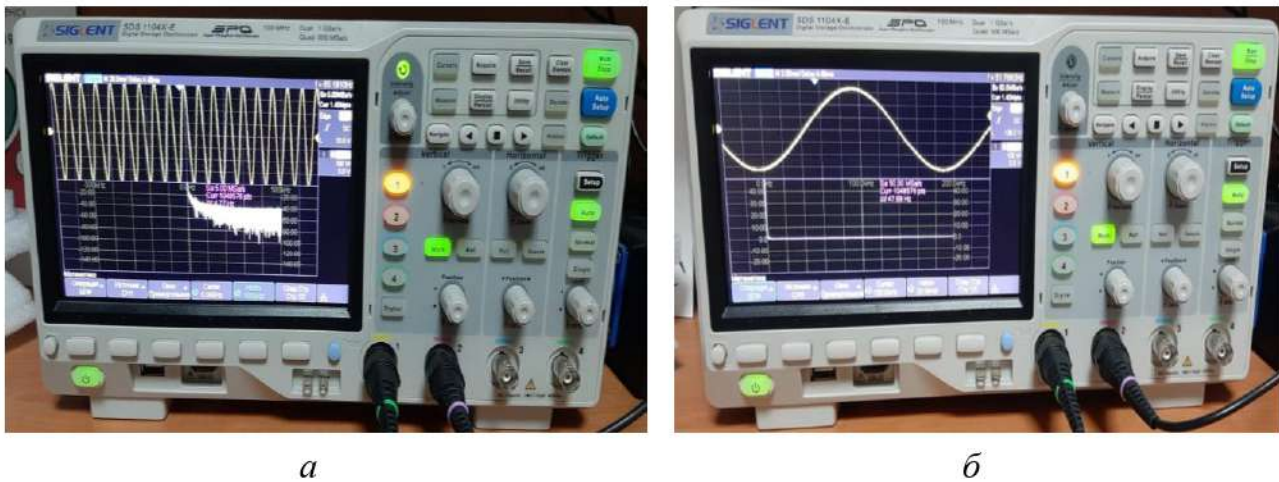
Рисунок 5.36 – Форма вихідної фазної напруги перетворювача частоти і його спектральний аналіз (швидке перетворення Фур'є):
