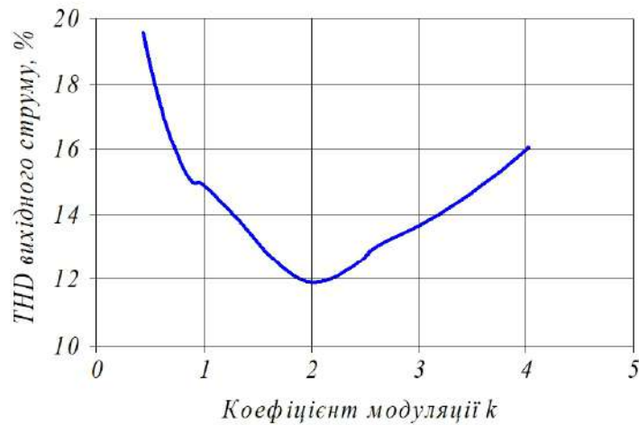
Рисунок 2.15 – Залежність THD вихідного струму від коефіцієнта модуляції
