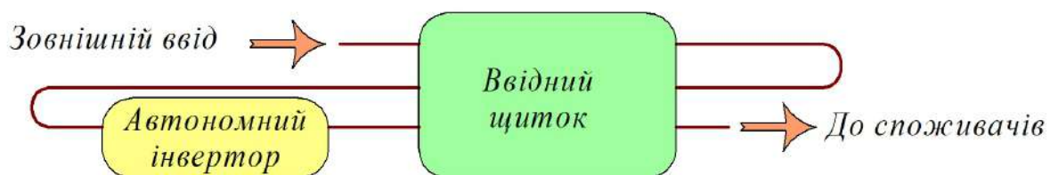
Рисунок 1.5 – Схема взаємодії зовнішньої мережі, автономного інвертора, ввідного щитка і споживачів у штатному режимі роботи
