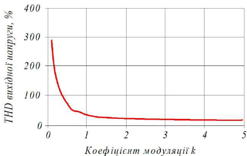
Рисунок 2.49 – Залежність коефіцієнта гармонічних спотворень вихідної напруги від коефіцієнта модуляції
