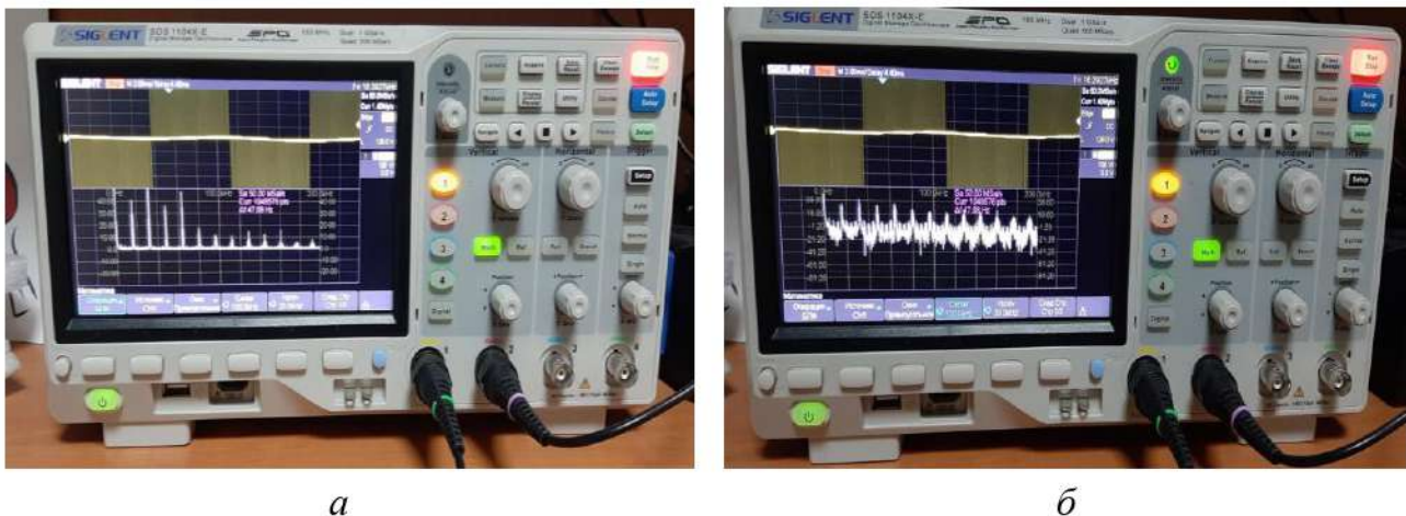
Рисунок 5.35 – Осцилограми вихідної лінійної напруги перетворювача частоти до фільтрації і його спектральний аналіз (швидке перетворення Фур’є): а – навантаженням є трифазний асинхронний двигун; б – навантаженням є три реостати, з’єднані зіркою
