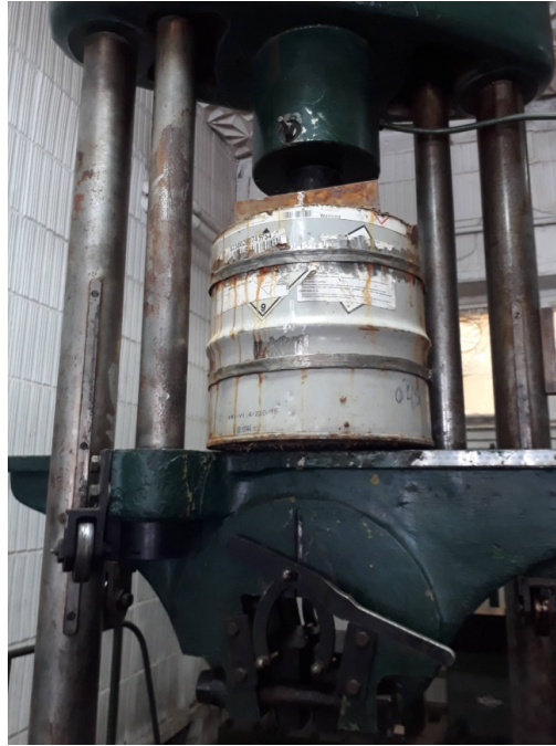
Рис. 3. Випробування моделі ґрунтополімерної композиції динамічним навантаженням
